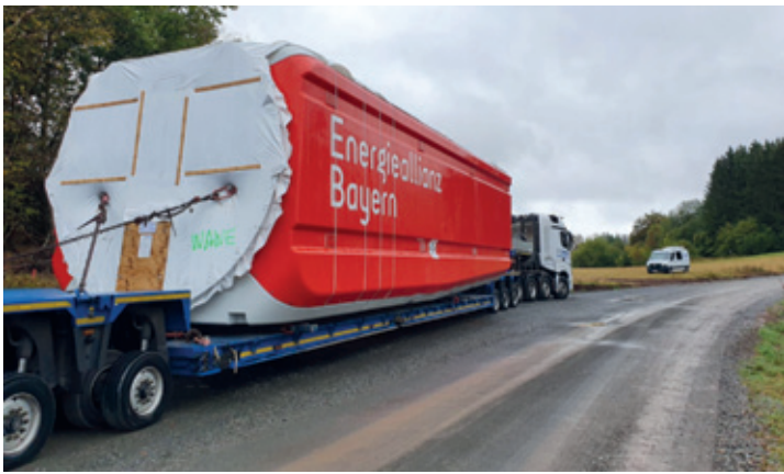
Eine der jüngsten Beteiligungen ist der neu entstehende Windpark Wadern im Saarland. Eine „Gondel“ mit Generator wird gerade auf einem Tieflader angeliefert.
